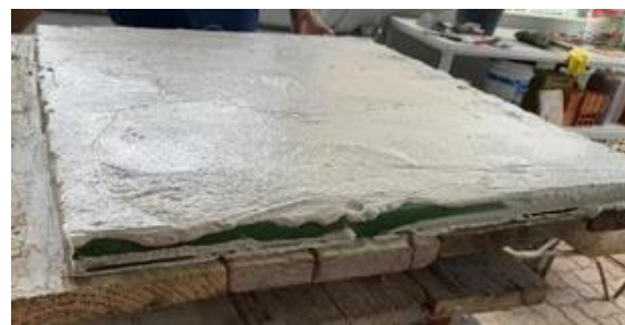
Figura 10: Protótipo com argamassa de estuque aplicado. Fonte: Acervo pessoal das autoras.
